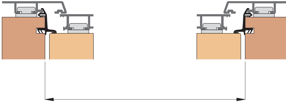
Dimension de la feuillure "B" - L x H Vue de l'intérieur des fenêtres et des cadres d'étanchéité
