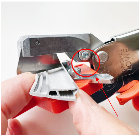
Ankippen der Dichtung beim Ausklinken
